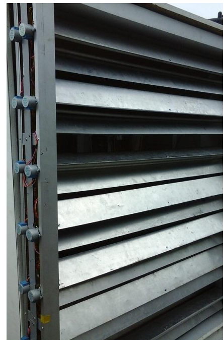
Gambar 5. Prototype beserta Sistem Gerak. (atas) tampilan prototype, (bawah kiri) sistem belt-driven, (bawah kanan) sistem one louver one motor Sumber: Dokumentasi Penulis, 2026
