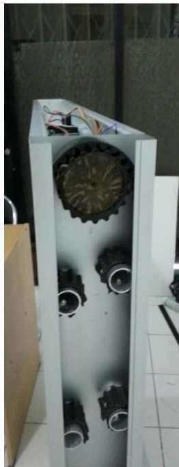
Gambar 5. Prototype beserta Sistem Gerak. (atas) tampilan prototype, (bawah kiri) sistem belt-driven, (bawah kanan) sistem one louver one motor Sumber: Dokumentasi Penulis, 2026
