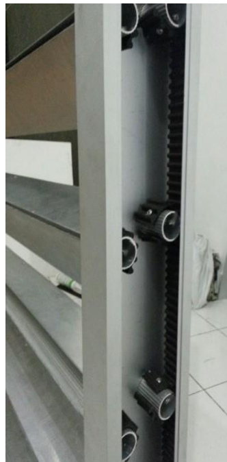
Gambar 5. Prototype beserta Sistem Gerak. (atas) tampilan prototype, (bawah kiri) sistem belt-driven, (bawah kanan) sistem one louver one motor Sumber: Dokumentasi Penulis, 2026
